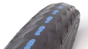
Ochranný pás je vidět, plášť musí být okamžitě vyměněn.
