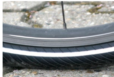
Tak by to mělo vypadat. Plášť není pod zátěží jezdce téměř zdeformován.
