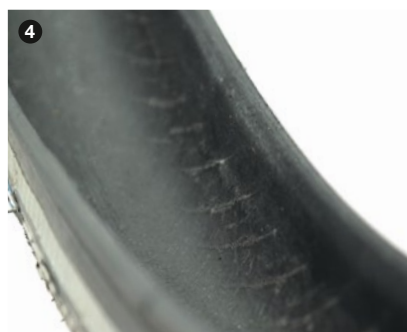
Stopy po jízdě s nedostatečným tlakem
