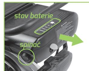
**Zjištění stavu nabité baterie:** pomocí LED indikátoru umístěného v zadní části baterie, který aktivujete stisknutím tlačítka. Baterie má plnou kapacitu, když svítí 4 LED diody (3 zelené, 1 červené). Pokud svítí pouze červená LED dioda, znamená to, že baterie je téměř vybitá a musí být co nejdříve nabita.
