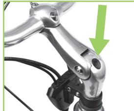
U modelů HAWK, MANITOU, YAMKA, MATTO je použit tzv. Ahead představec. Zde je potřeba nejdříve povolit čepičku stahovacího ježka a následně 2 šrouby stahující představce na sloupku vidlice.
