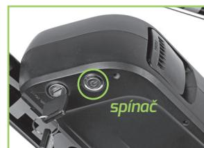
**Zjištění stavu nabité baterie:** pomocí LED indikátoru umístěného na boku baterie, který aktivujete stisknutím a přidržením tlačítka. Baterie má plnou kapacitu, když svítí 4 LED diody (3 zelené, 1 červené). Pokud svítí pouze červená LED dioda, znamená to, že baterie je vybitá a musí být co nejdříve nabita.
