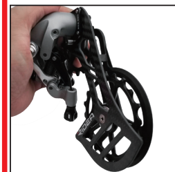
8 Přidržte rukou tělo měniče a OVERSIZE vodítko v žádoucí pozici.
