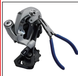
3 Pomocí zúžených plochých kleští opatrně vyjměte čep z těla měniče.
