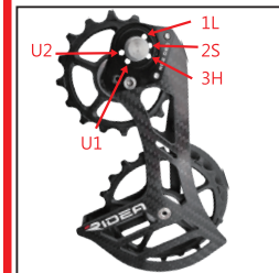
5 Vnější/vizuální část OVERSIZE vodítka má tři západky (1L 2S 3H), které nabízí možnost nastavení tenze pružiny, vyberte pro Vás žádoucí pozici. Západky (U1 U2) jsou vhodné pro starší verzi pružiny.
