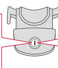
Doba nabíjení cca. 2 h při 5V 200 mA / Czas ładowania ok. 2 h przy 5 V, 200 mA / Urządzenie ładuje się w czasie ok. 2 h z uwzględnieniem parametrów ładowania 5V 200 mA / Ladetid ca. 2 t. ved 5 V, 200 mA
