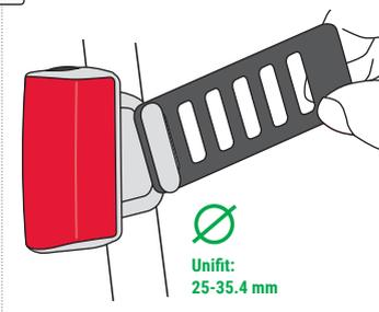
**DK** Inden montage rengøres og affedtes sadelstøtten for at sikre en fast montering. Ved fastgørelsen observeres, at silikonebåndet spændes og anbringes så fast, at baglygten ikke kan forskyde sig eller justeres let. Monteringshøjde mellem 250 og 1200 mm.
