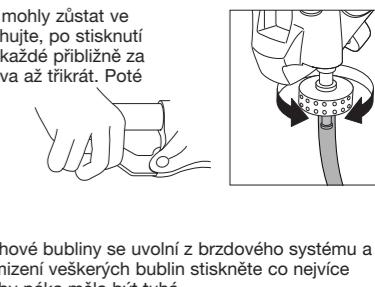
8. Pokud nyní stlačíte brzdovou páku, vzduchové bublinky se uvolní z brzdového systému a kanálkem se dostanou do nálevky. Po vymízení veškerých bublin stiskněte co nejvíce brzdovou páku. Za normálních podmínek by páka měla být tuhá.
